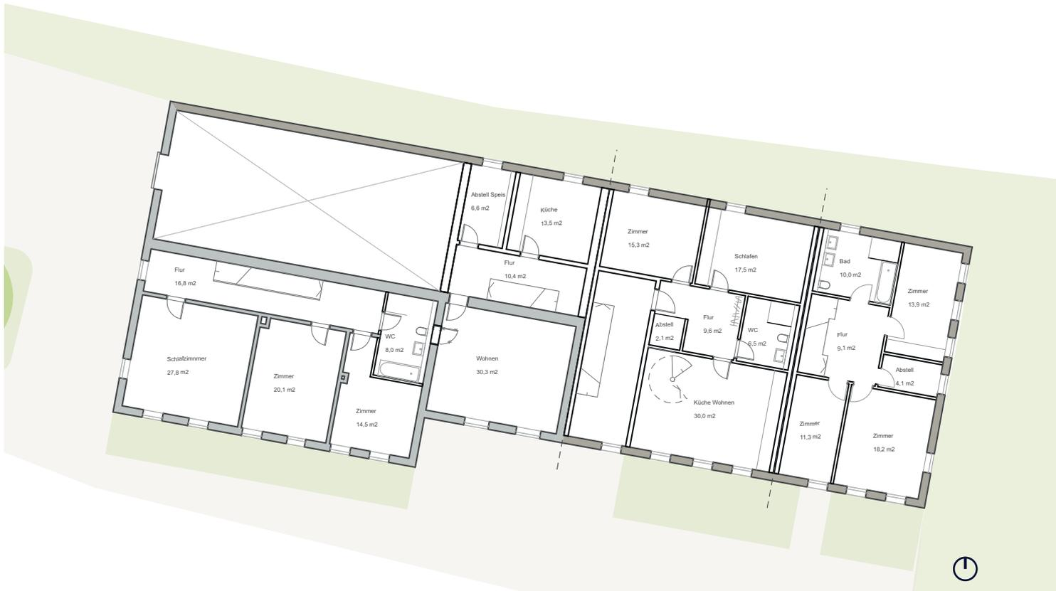
ortegestalten: Testentwurf V1 // „Alte Hülle - Neuer Inhalt“ - Obergeschoss M 1:250
