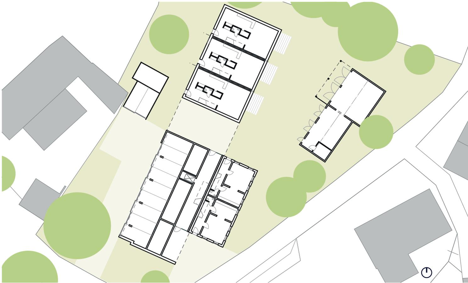
ortegestalten: Testentwurf V1 // Umnutzung Bestand + Neubau - Erdgeschoss M 1:500
