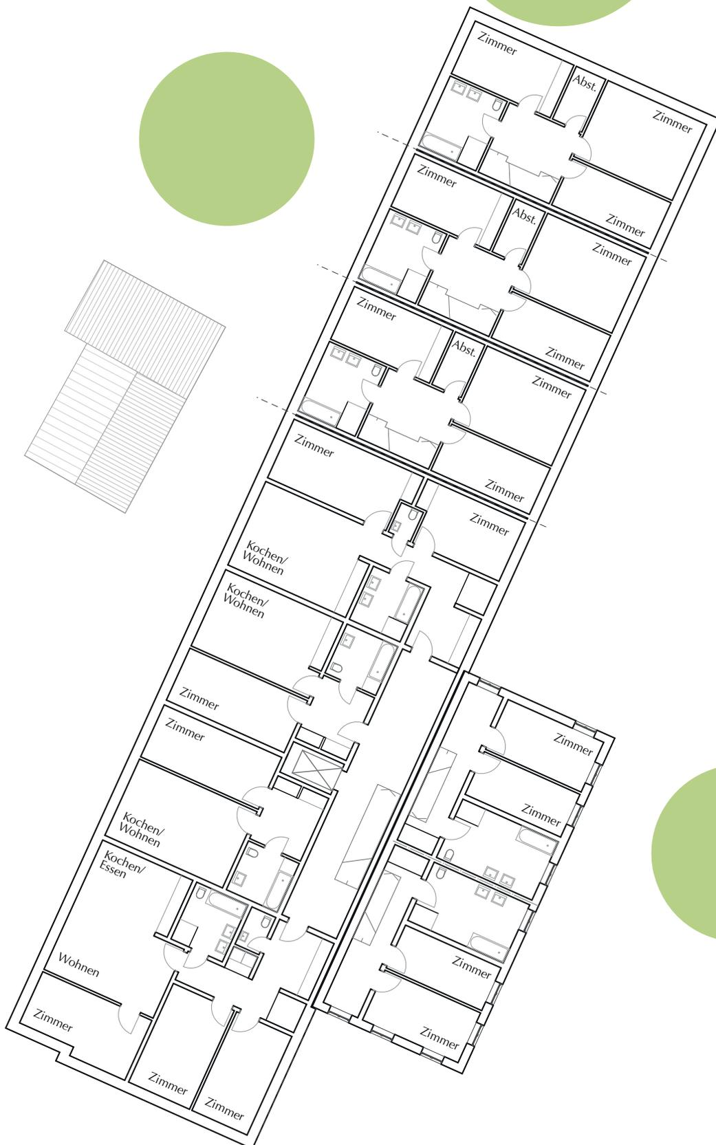
ortegestalten: Testentwurf V1 // Umnutzung Bestand + Neubau - Obergeschoss M 1:250
