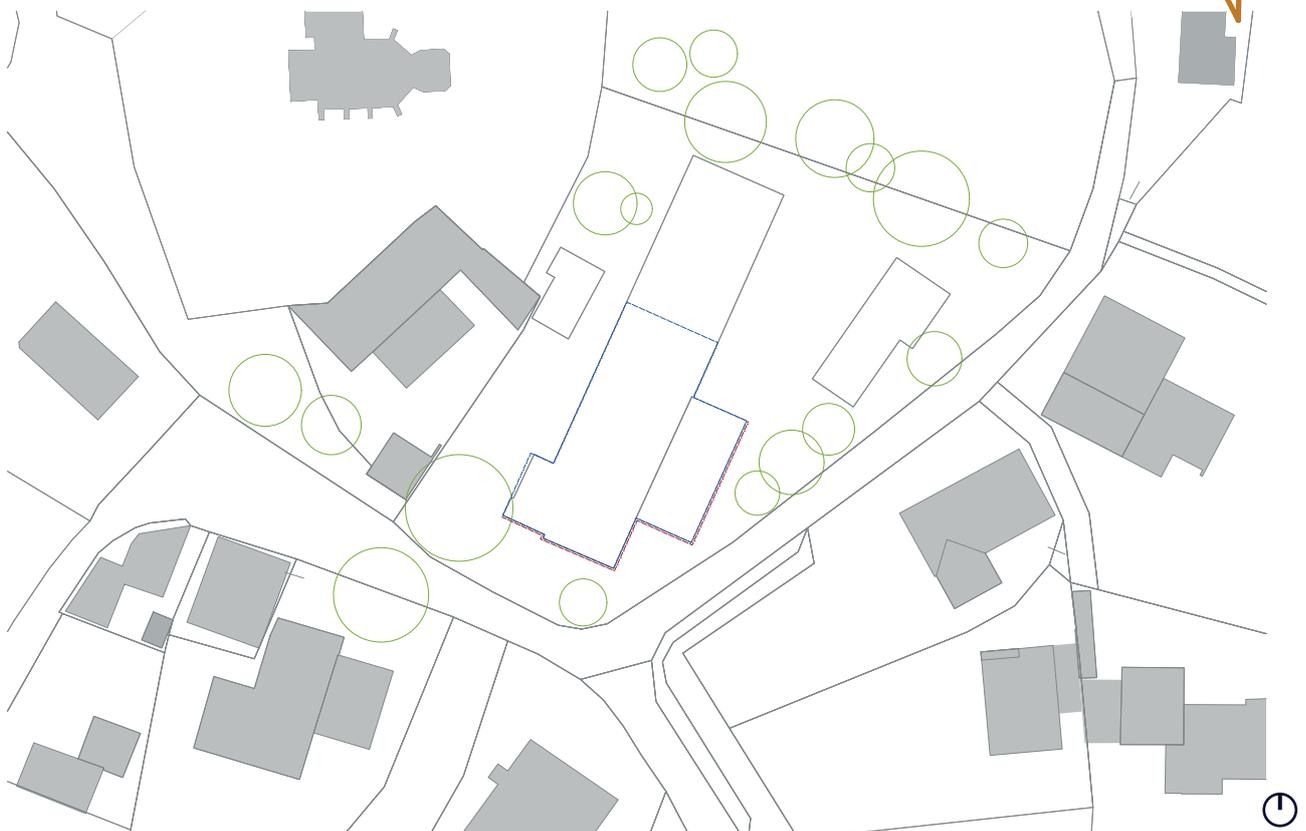
Baufelder und Bauvolumen analog Bestand - Lageplan M 1:1000
